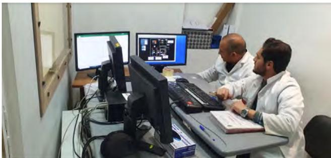
Ce système, contrôlé par ordinateur, est doté d'un logiciel unique qui permet un fonctionnement manuel et automatisé, où tous les composants clés peuvent être contrôlés, y compris les pompes, les vannes, la capture vidéo et l'acquisition de données. Un séquenceur de test permet également de réaliser des séquences de test automatisées. Les objectifs comprennent la mesure de la perméabilité et la perméabilité relative.
