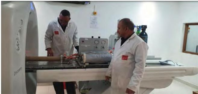
Il s'agit de mener des essais en laboratoire, essais consistant à injecter, sous une pression de confinement pouvant atteindre les 5000 PSI et une température de 120°C, un fluide ou une combinaison de fluides dans un échantillon prélevé dans le réservoir. L'objectif est de réaliser des études d'injection de liquides/liquides ou gaz/liquides monophasés et multiphasés dans des conditions de température et de pression représentatives du réservoir.
